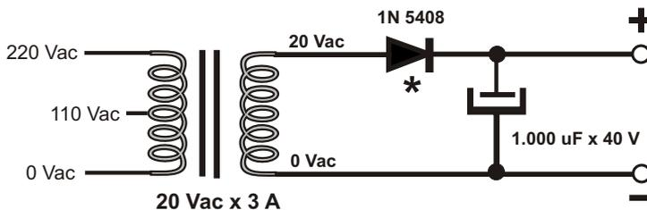
\* A retificação poderá ainda ser em onda completa , substituindo-se o diodo 1N 5408 por uma ponte retificadora !
